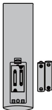
Entnehmen Sie bereits eingelegte Batterien und legen Sie die neuen Batterien in die Fernbedienung ein. Achten Sie beim Einlegen der Batterien auf die Polarität (+/-) im Batteriefach.
