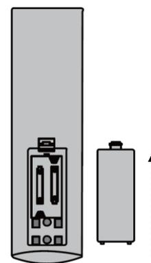
Schließen Sie das Batteriefach auf der Rückseite der Fernbedienung, indem Sie die Abdeckung in Pfeilrichtung auf die Fernbedienung schieben.
