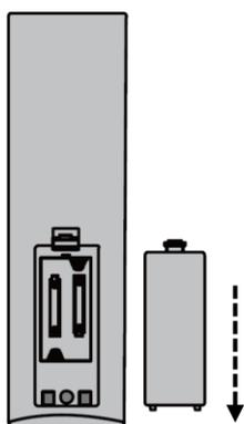
Öffnen Sie das Batteriefach auf der Rückseite der Fernbedienung, indem Sie die Abdeckung in Pfeilrichtung von der Fernbedienung herunterschieben.
